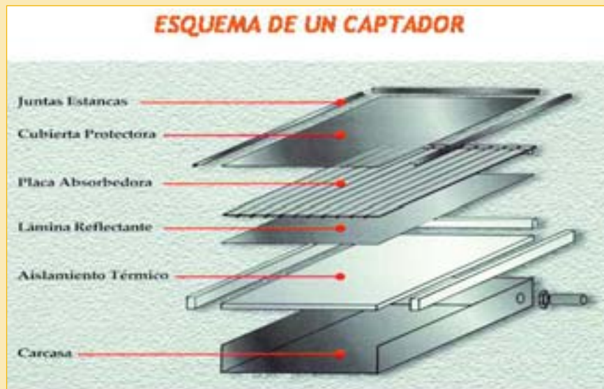
Figura 2: Captador solar plano.
